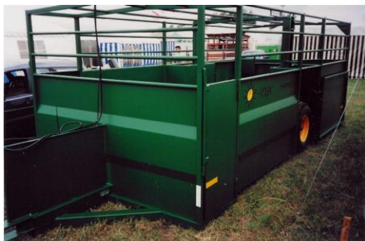
Abb. 6: Hydraulisch absenkbarer Transportwagen; Foto: A-Hyten
